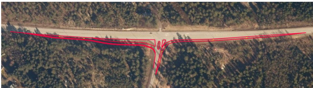
Kuva 33 Erotettu oikealle kääntyvien kaista sekä kiihdytyskaista Bollstantieltä itään.
