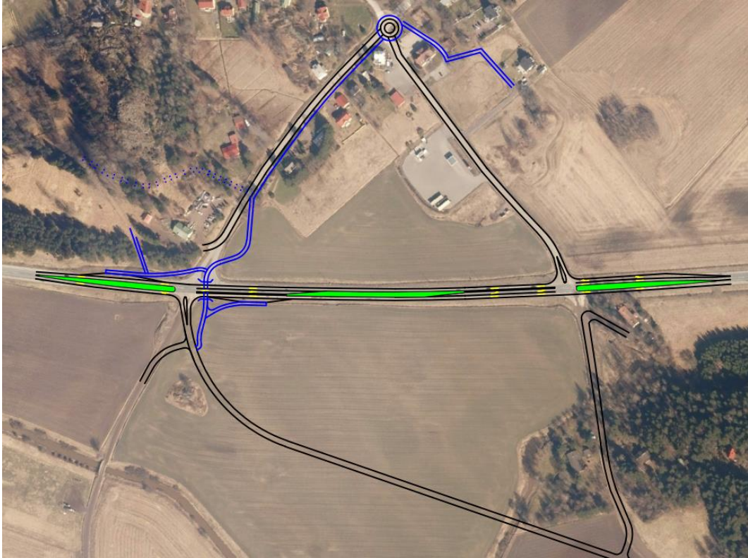
Kuva 51 VE2: Tonttukaari ja Kopparnäsintien liittymät suljetaan, alikulku Tonttukaaren ja Torbackantien päätyyn. Ajoneuvoliikenteen järjestelyt on esitetty mustalla ja jalankulun ja pyöräilyn yhteydet sinisellä.
