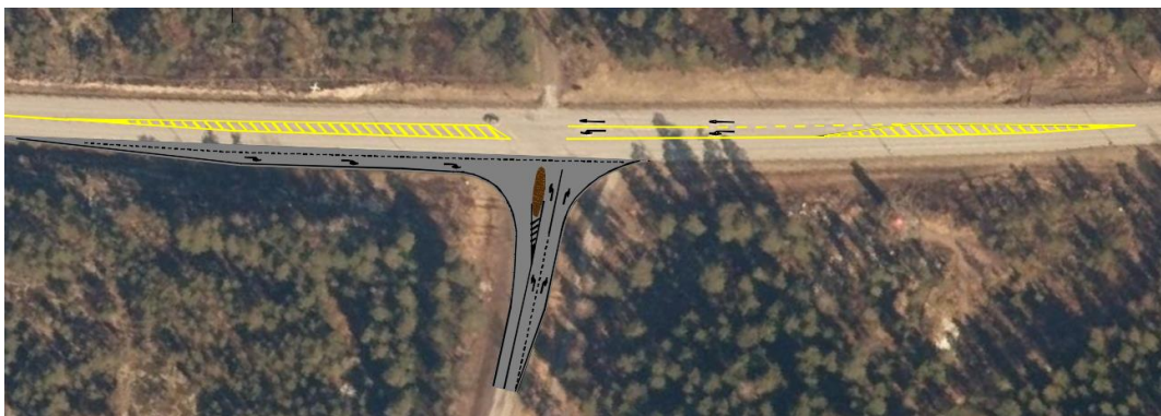
Kuva 34 "Perinteinen" oikealle kääntyvien kaista sekä ryhmittymiskaistat Bollstantiellä.
