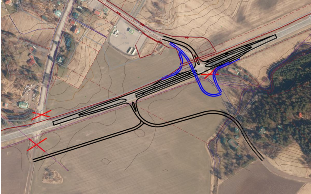
Kuva 55 VE6: Tonttukaaren, Torbackantien ja Kopparnäsintien nykyiset liittymät suljetaan, uusi liittymä Kopparnäsintielle rakennetaan porrastetusti. Kevyen liikenteen alikulku/ylikulku Degerbyntien ja Kopparnäsintien liittymäalueen yhteyteen.
