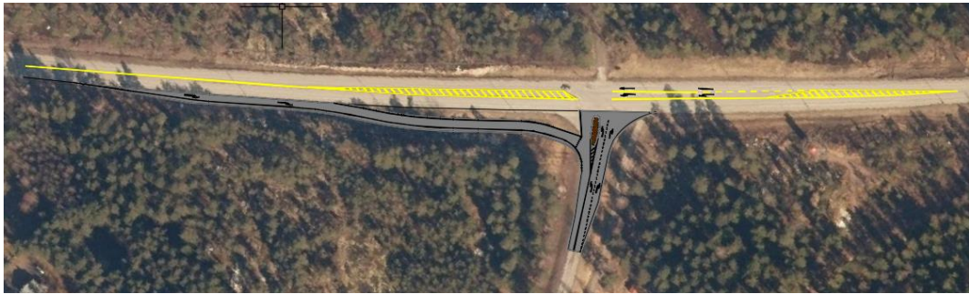
Kuva 35 Erotettu oikealle kääntyvien kaista sekä ryhmittymiskaistat Bollstantiellä.
